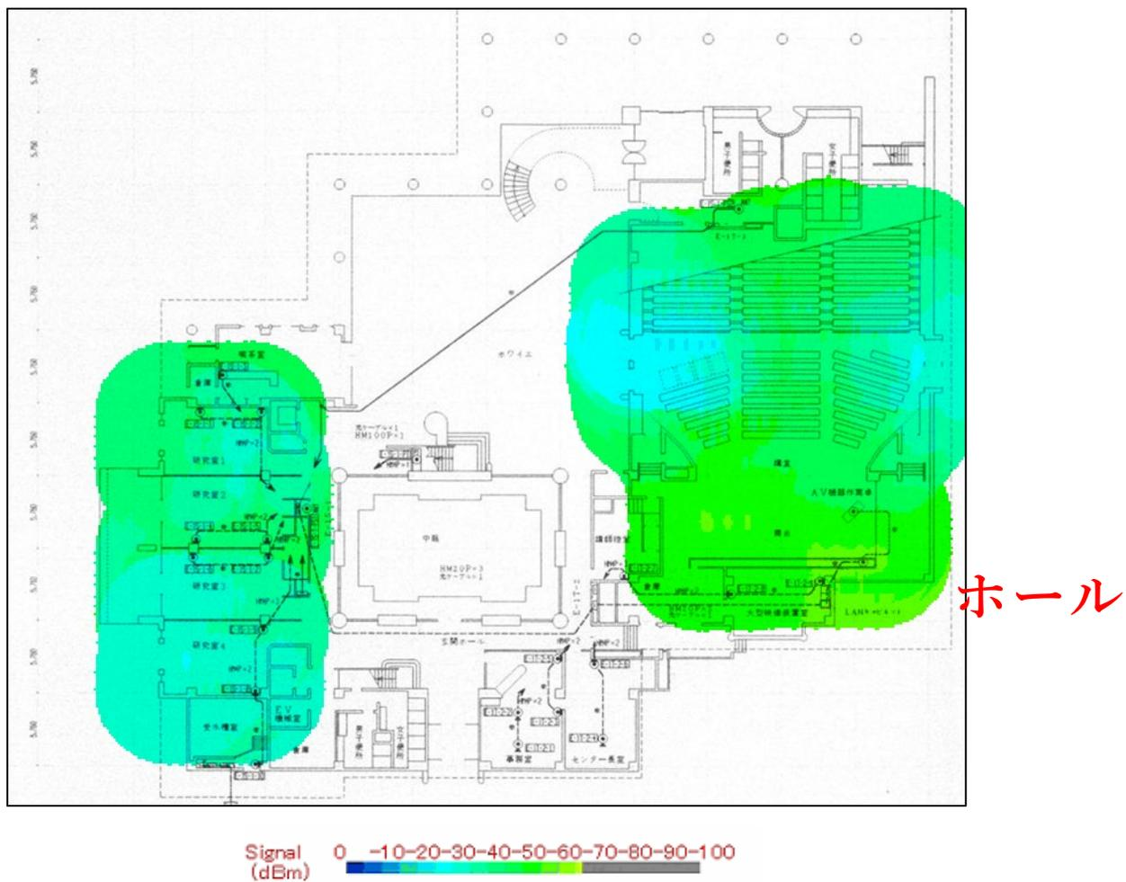
図 7. 5GHz 帯全体の受信信号強度
